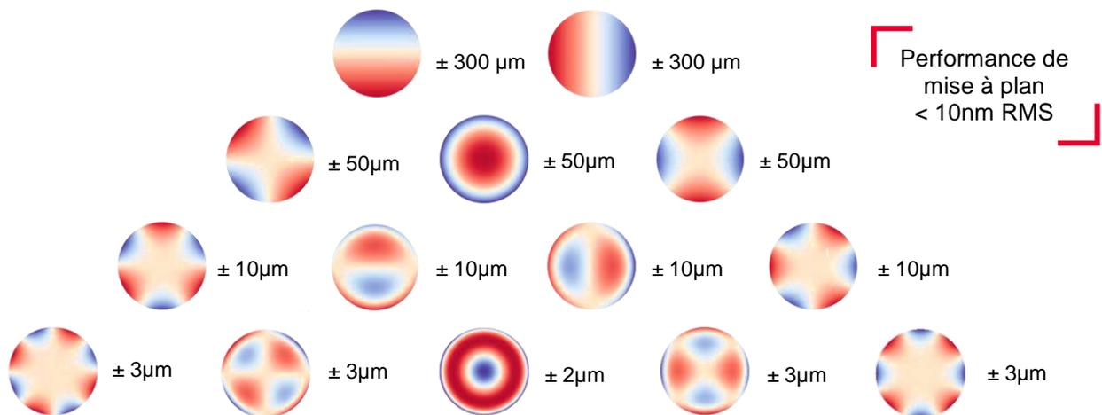
L'amplitude PtV est liée à un diamètre d'ouverture circulaire de 85 mm. En fonction des modes, les erreurs résiduelles « rms » du front d'onde représentent entre 0.1% and 1% de la correction.
