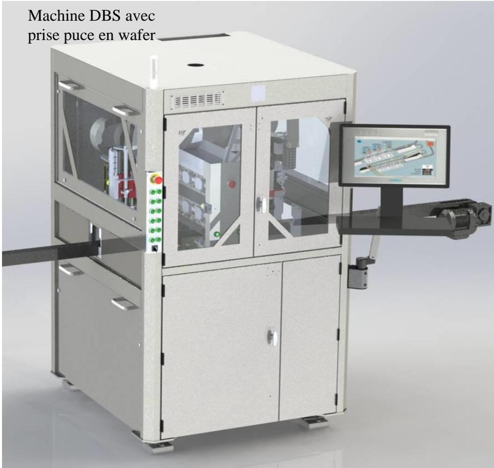
**La machine DBS (Die Bonder Station) permet de déposer une puce dans un régulateur, sur une zone préalablement encollée.**
