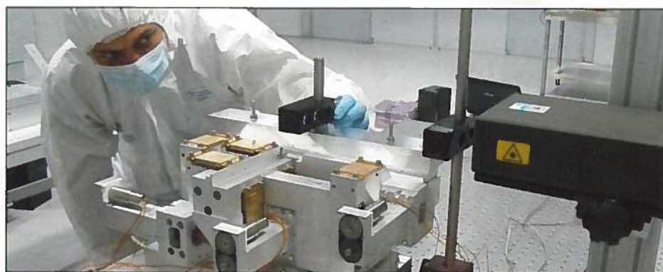
Contrôle par interférométrie laser d'un positionneur 6 axes UHV. Source : ISP System
