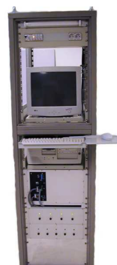
Baie de pilotage
