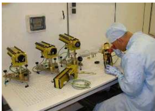
Outillages de visée équipés de lunette télescope en cours de montage
