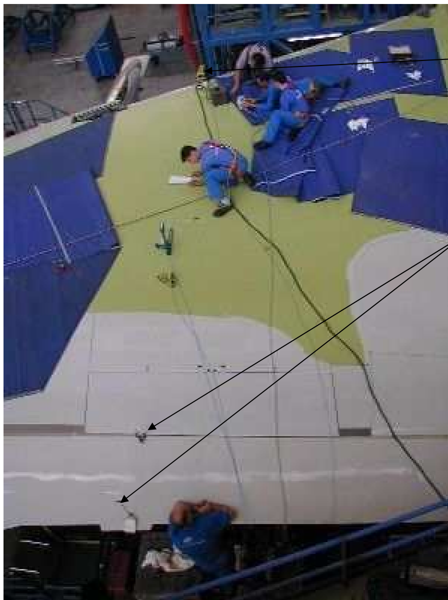
Outillages de visée équipés de lunette télescope en cours de montage
